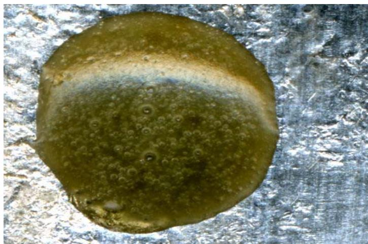
Рис. 6. Образец обезжелезенного стекла
